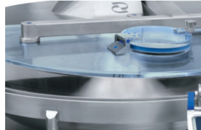
The check opening hole in the bowl cover Orificio para dosificar los ingredientes en el bol
