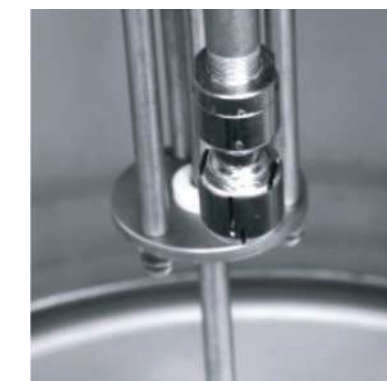
dysza myjąca obrotowa rotating washing nozzle
